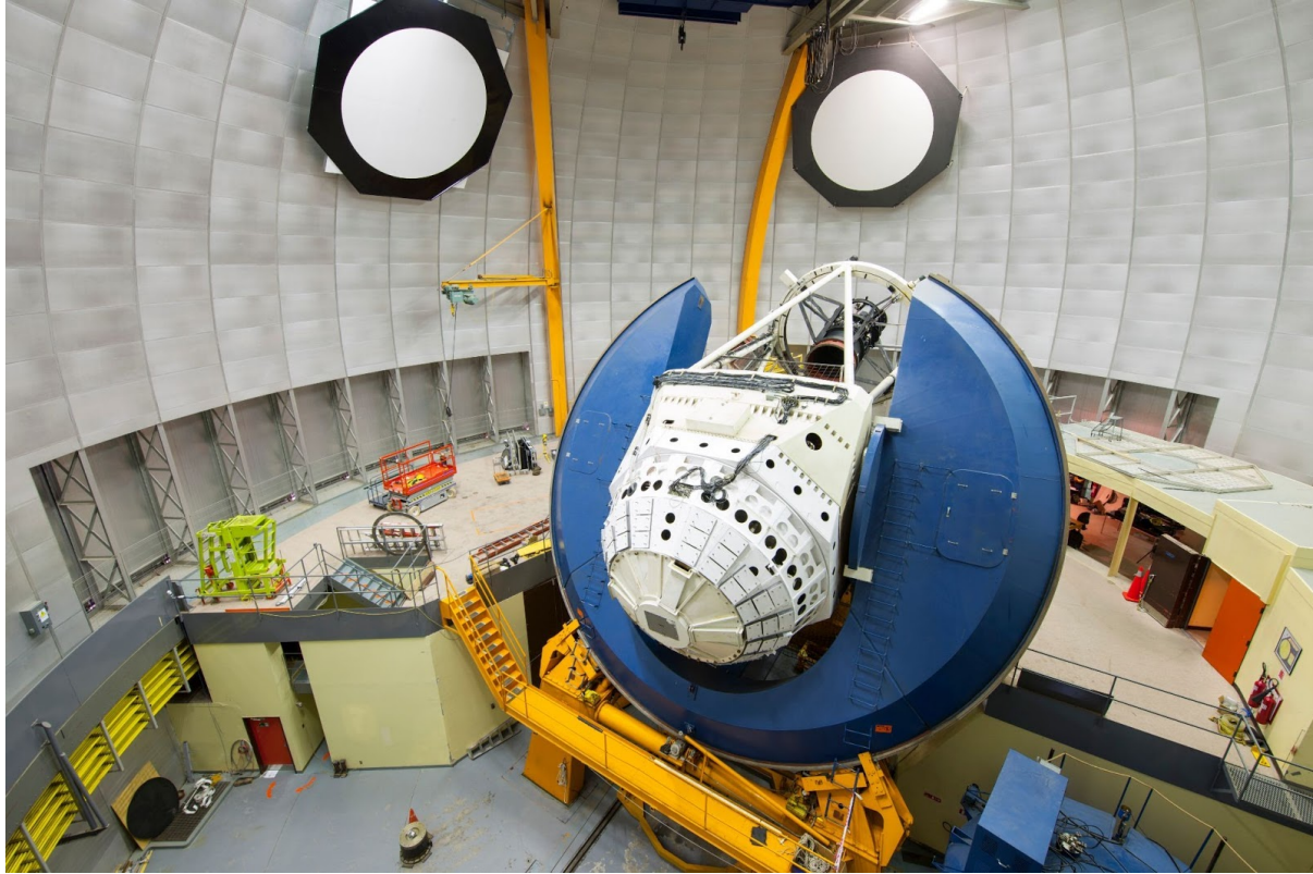
Il telescopio Blanco, 4 metri di diametro, dal quale è stato realizzato il progetto DES. Il cilindro nero contiene DECam, la camera utilizzata per fotografare le galassie. Crediti immagine: Reidar Hahn y Fermilab.
